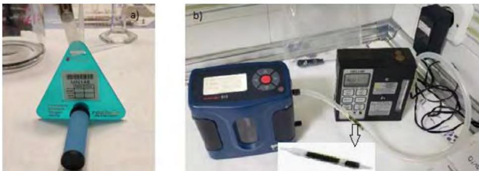
**Figura 5.1.** a) captador pasivo Radiello®, que consta de un cuerpo difusor azul en cuyo interior se encuentra el cartucho relleno de un adsorbente; b) captador activo SKC, relleno de dos secciones de carbón activo y conectado a una bomba de muestreo y un calibrador para determinar el flujo de muestra.
