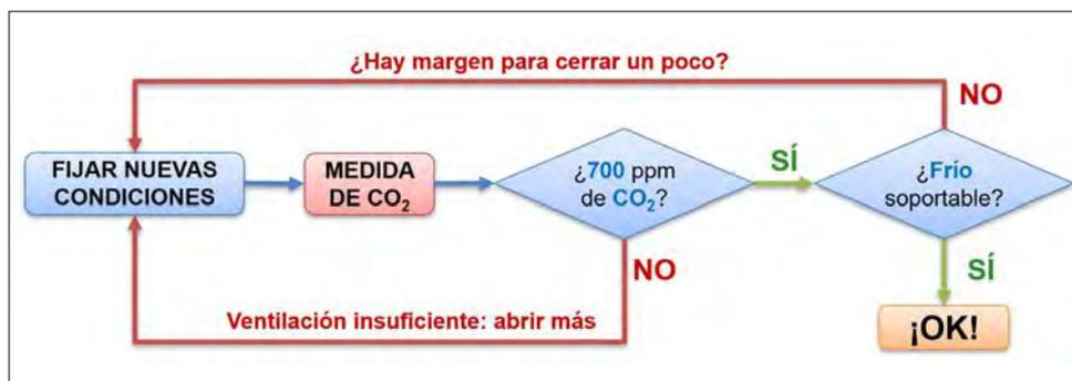
Figura 9.5. Diagrama con pasos para reajustar las condiciones de ventilación.
