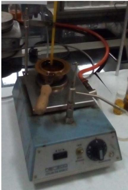
Figura 17.8. Equipo para la determinación del punto de inflamación.
