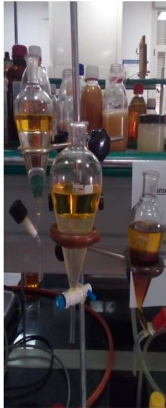
**Figura 17.5.** Reacción de transesterificación (izquierda) y lavados de biodiésel (derecha).
